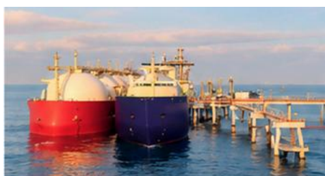
FSRU-BASED LNG IMPORT TERMINAL
